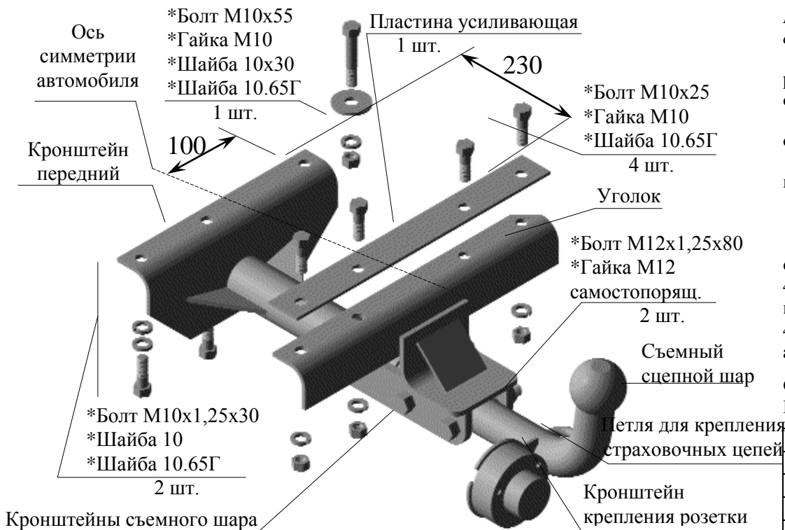
Рис.1 Тягово-сцепное устройство ТСУ ДЭУ МАТИЗ.
