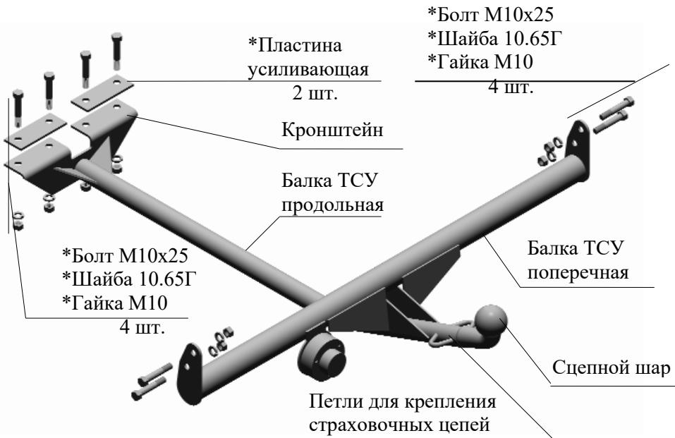
Рис.1 Тягово-сцепное устройство 2106 в сборе
